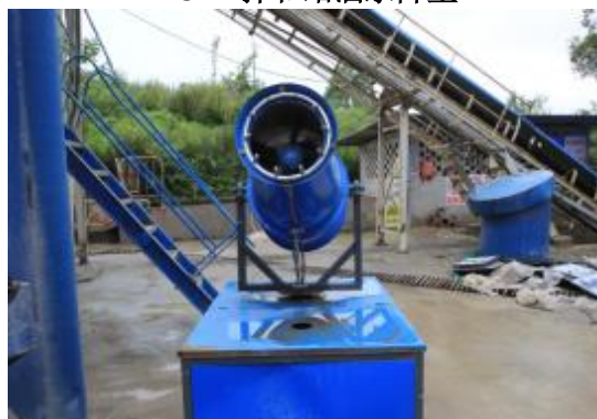
ZCB2 拌和站配备雾炮机
