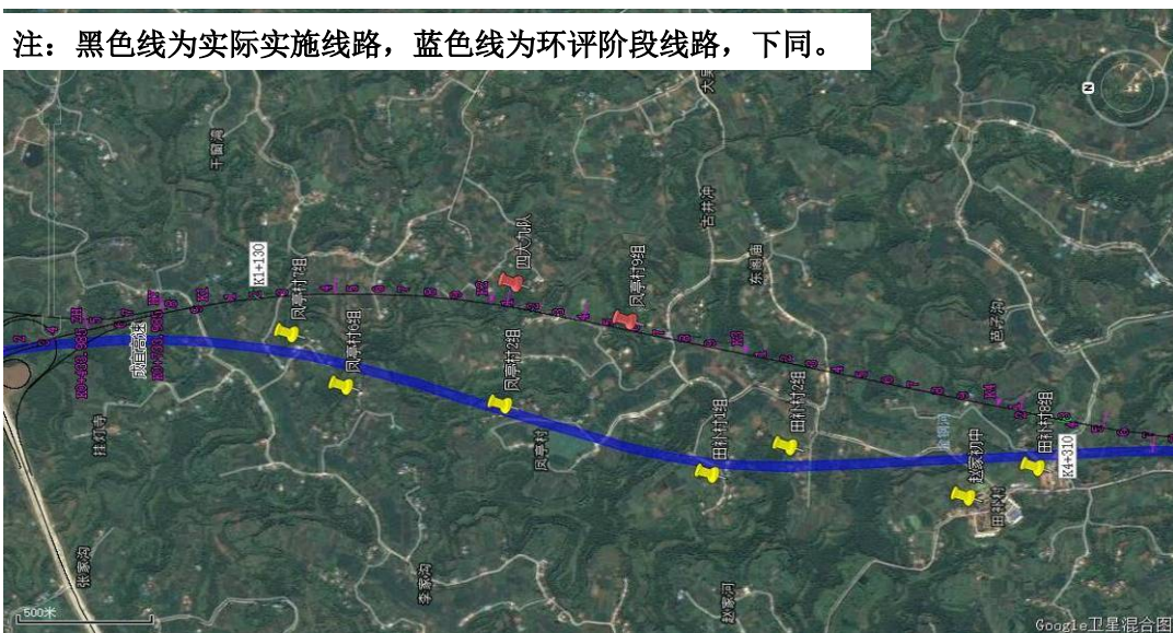
图 3.8-1 K1+130~ K4+310 段工程线路位移情况
